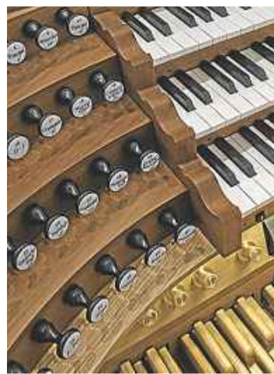
Der Spieltisch mit den Zügen für die 50 Register der Orgel, der Tastatur und den Pedalen.
