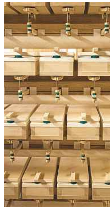
Ein technisches Meisterstück der neuen Orgel wird die sogenannte Barker-Maschine (Ausschnitt Bild links). Zusammengesetzt ist sie aus zahlreichen, blasebalgähnlich geformten Einzelstücken (Bild oben). Die frühere Stadtkirchenorgel kannte – elektrisch gesteuert – für die einzelnen Pfeifenventile nur ein Auf oder Zu. Die Barker-Maschine dagegen arbeitet mechanisch, ein dosierter Druck des Organisten auf die Tasten wird auch in eine dosierte Belüftung und damit Ansprache der einzelnen Orgelpfeifen übertragen.
