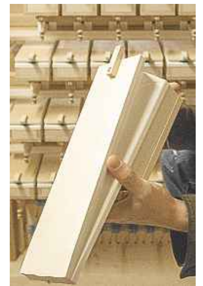
Ein technisches Meisterstück der neuen Orgel wird die sogenannte Barker-Maschine (Ausschnitt Bild links). Zusammengesetzt ist sie aus zahlreichen, blasebalgähnlich geformten Einzelstücken (Bild oben). Die frühere Stadtkirchenorgel kannte – elektrisch gesteuert – für die einzelnen Pfeifenventile nur ein Auf oder Zu. Die Barker-Maschine dagegen arbeitet mechanisch, ein dosierter Druck des Organisten auf die Tasten wird auch in eine dosierte Belüftung und damit Ansprache der einzelnen Orgelpfeifen übertragen.
