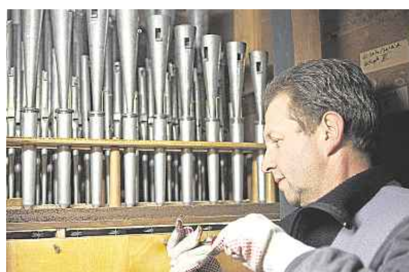
Einige der Orgelpfeifen haben nie geklungen, sondern waren nur zur Zierde am Korpus angebracht (links). Sie sollen zu Christbaumschmuck umgearbeitet werden. Horst Hoffmann baut die Pfeifen aus den Registern aus.
