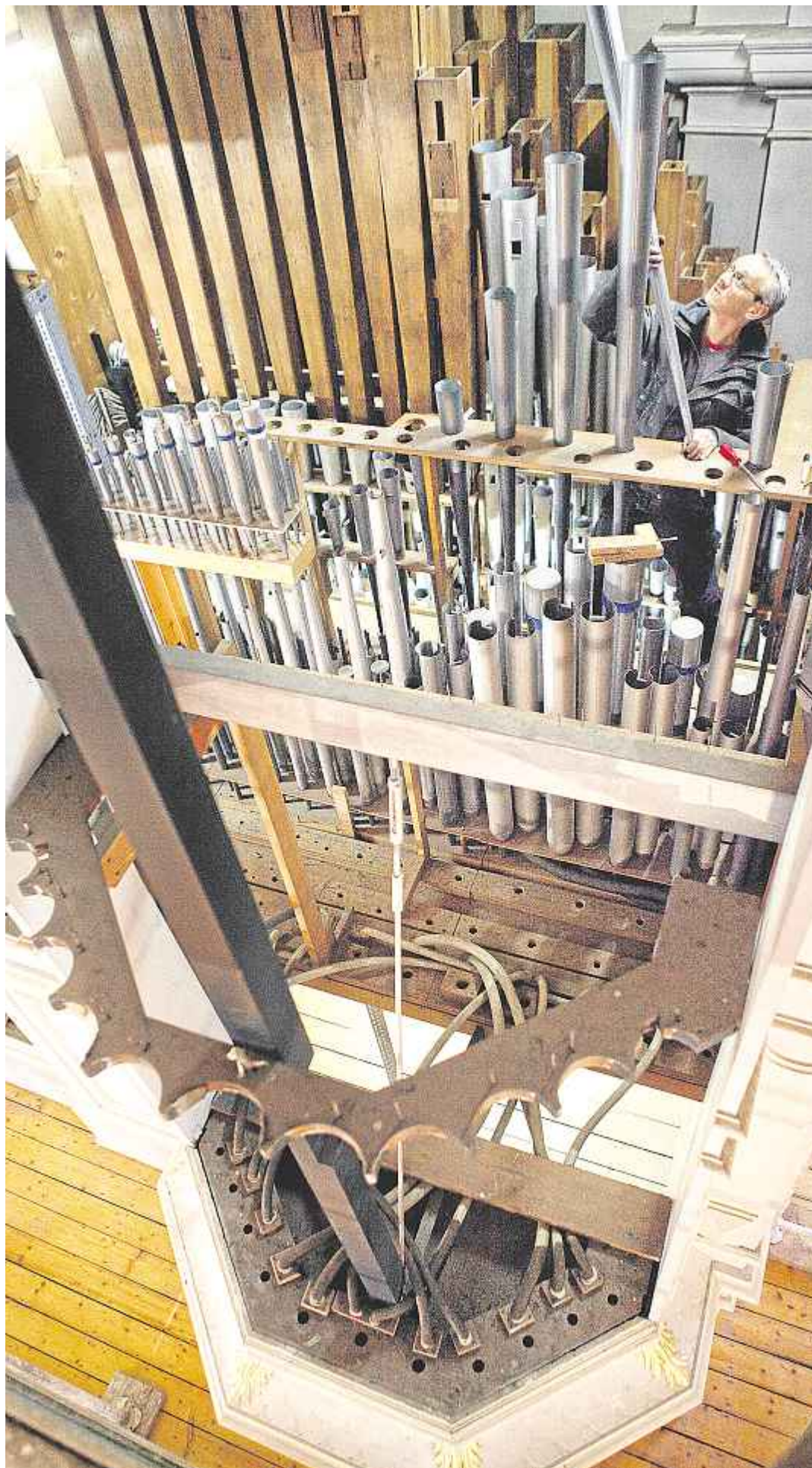
Norbert Wisnewski im Inneren der Orgel. Vorne sind Plastikschläuche zu sehen, die aus der Sanierung von 1960 stammen.
